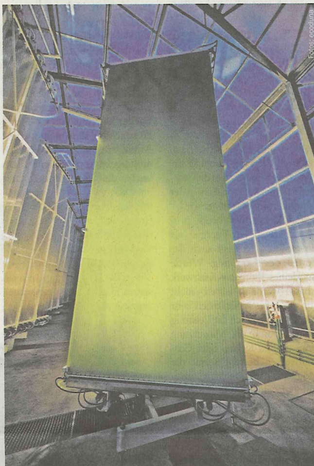
Algen werden in Photobioreaktoren gezüchtet, damit sie als Rohstoff verwendet werden können.
